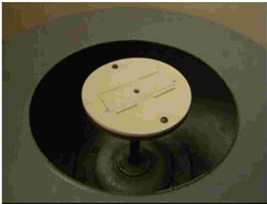
9 сурет – Төсемені бекітуге арналған алаңшасы бар центрифуга роторы.
